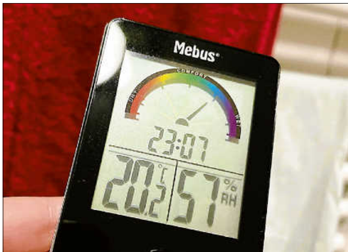
Hygro-Thermometer zeigen an, ob Temperatur und Luftfeuchtigkeit in einem günstigen Verhältnis liegen. Foto: LEA
